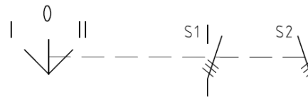
Схема переключателя КЕМ/КЕА VV
